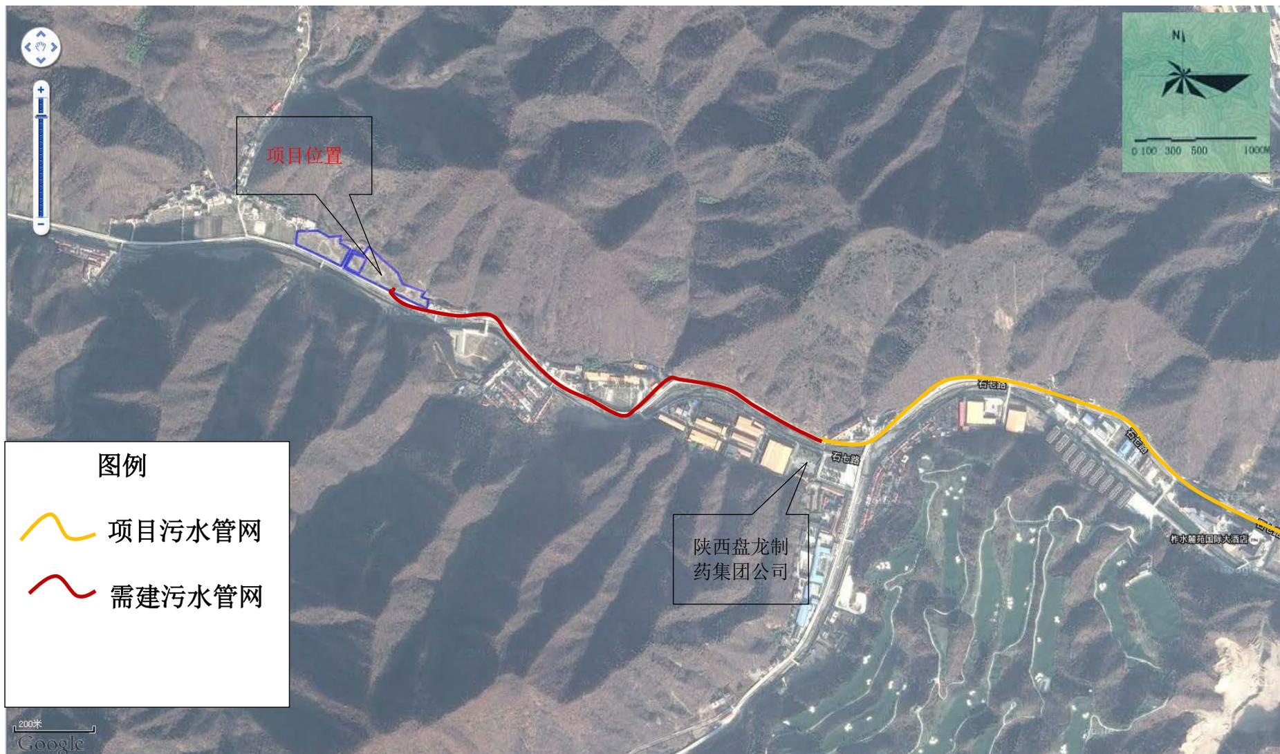
附图六 项目污水输送管网图
